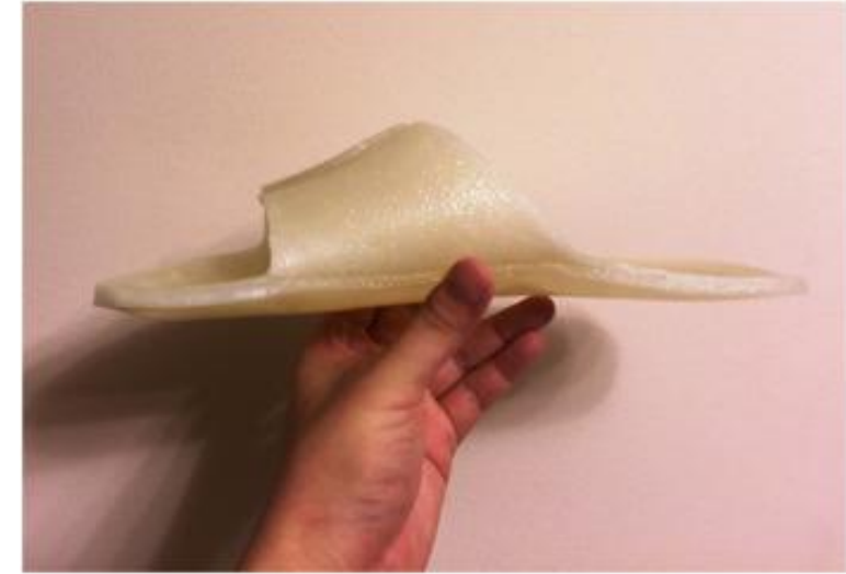
Şekil 11: Sun ve arkadaşları tarafından geliştirilen şekil hafızalı terlik prototipi (Sun vd., 2017).
