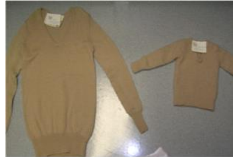
Şekil 9: SMP ile muamele edilmiş yünlü giysilerin geliştirilmiş boyutsal stabilitesi (Hu J. vd., 2012).
