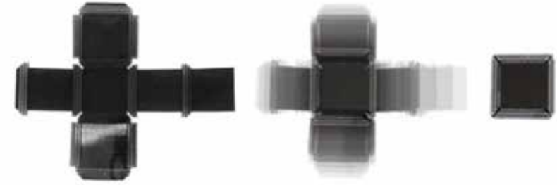
Şekil 3: Üç boyutlu bir küp halinde katlanabilen 4D baskılı tel.
