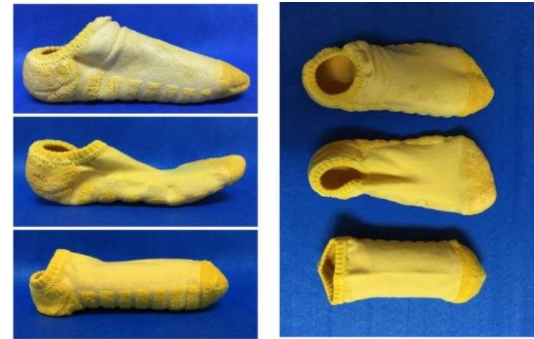
Şekil 12: Sun ve arkadaşları tarafından geliştirilen şekil hafızalı çorap ayakkabıların yandan ve üstten görünüşleri (Sun vd., 2017).
