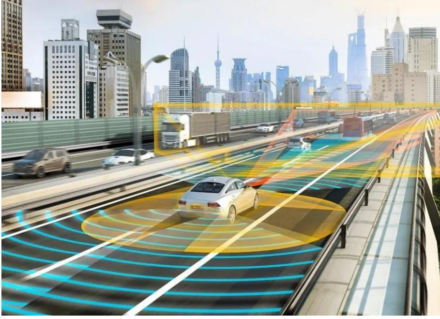
RoboTaxiler; radar, bilgisayar görüşü, Lidar, sonar, GPS, odometre ve atalet gibi ölçüm birimleri kullanıyor
