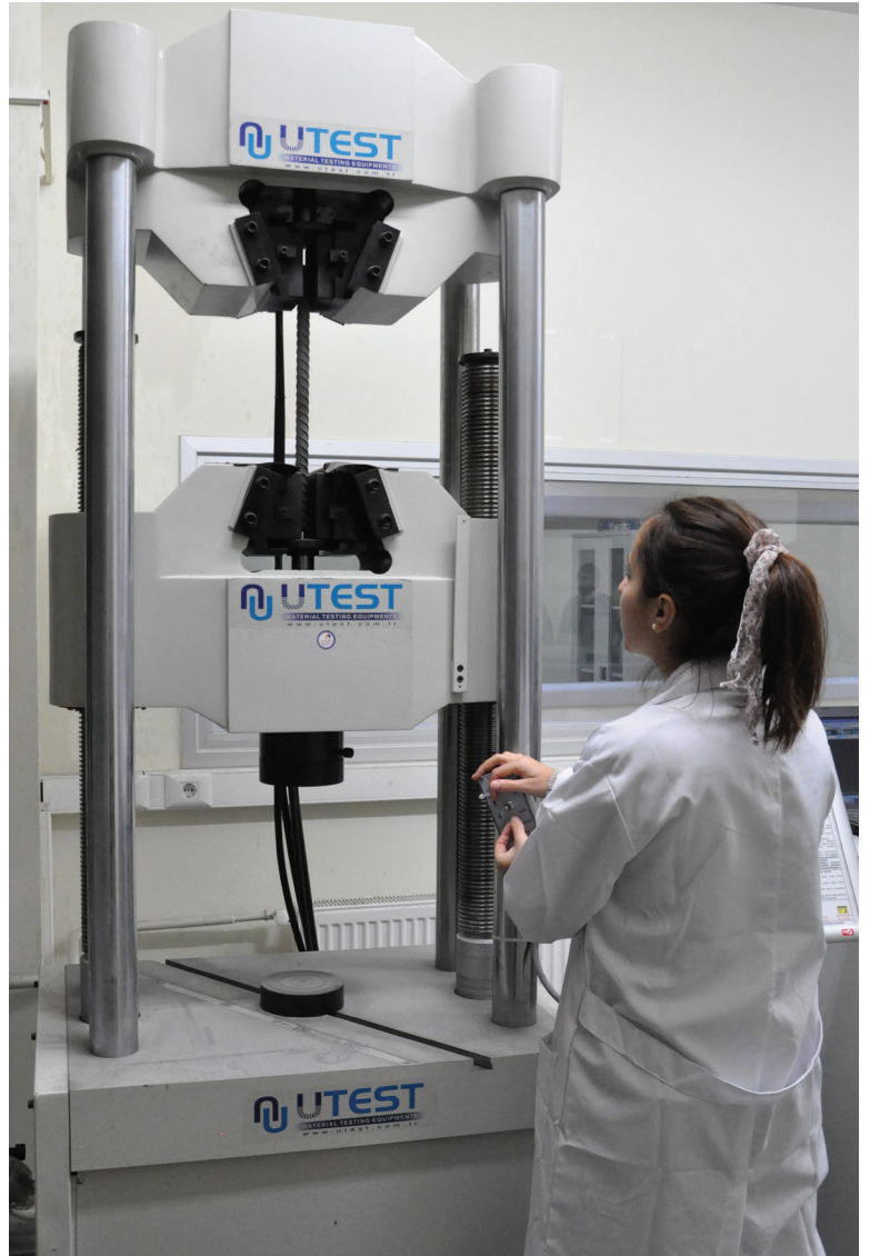
1000 kN Kapasiteli Donatı Çeliği Çekme ve Basınç Gövdesi Hydraulic Universal Testing Machine, Servo Controlled, 1000kN
