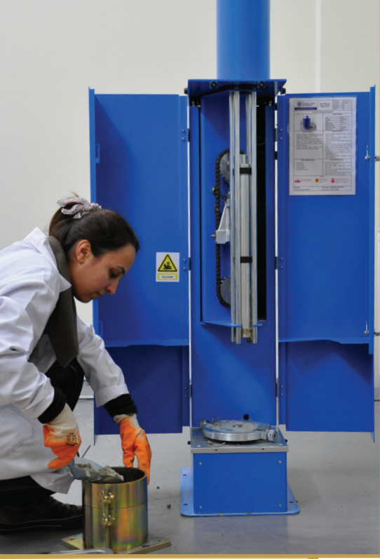
Otomatik Toprak Kompaktörü(standart ve modifiye kalıp ve tokmaklar) Automatic Soil Compactor With Standard and Modified Proctor
